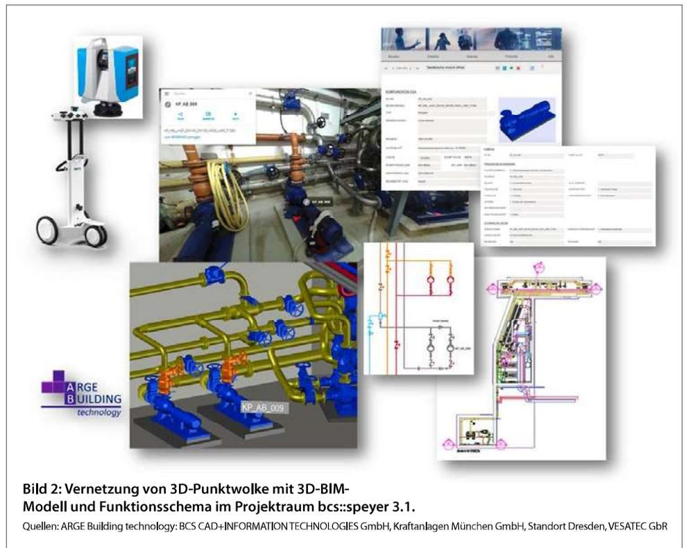
**Bild 2: Vernetzung von 3D-Punktwolke mit 3D-BIM-Modell und Funktionsschema im Projektraum bcs::speyer 3.1.**
